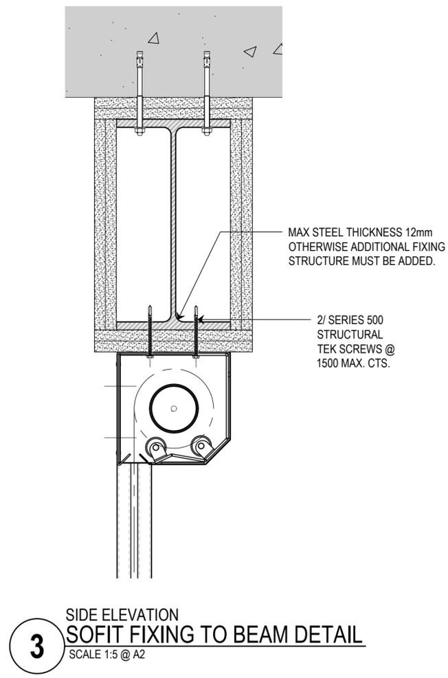
**3** SIDE ELEVATION SOFIT FIXING TO BEAM DETAIL
